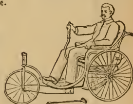
VOITURE à LEVIER actionnée et dirigée au moyen d'une seule main.
